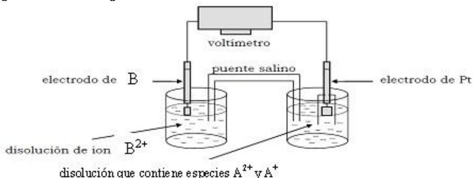
3) El *diagrama* de una celda galvánica es la representación simplificada de los procesos y los estados físicos de las reacciones electroquímicas en la celda. Para el ejemplo anterior, el diagrama de la celda galvánica es el siguiente:
