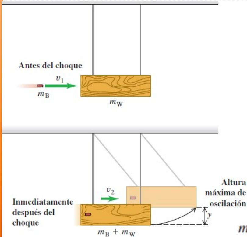
La figura muestra un péndulo balístico, un sistema sencillo para medir la rapidez de un proyectil. La bala, con masa  $m_B$ , tiene un choque totalmente inelástico con un bloque de madera de masa  $m_W$  que cuelga como péndulo. Después del impacto, el bloque oscila hasta una altura máxima  $y$ . En términos de  $y$ ,  $m_B$  y  $m_W$ , ¿qué rapidez inicial  $v_1$  tiene la bala?
