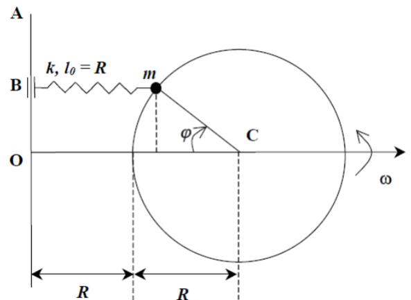
Todo el sistema gira con respecto al eje  $OC$  con velocidad angular  $\omega$  constante respecto a un sistema fijo. Consideramos que no actúa el peso.
