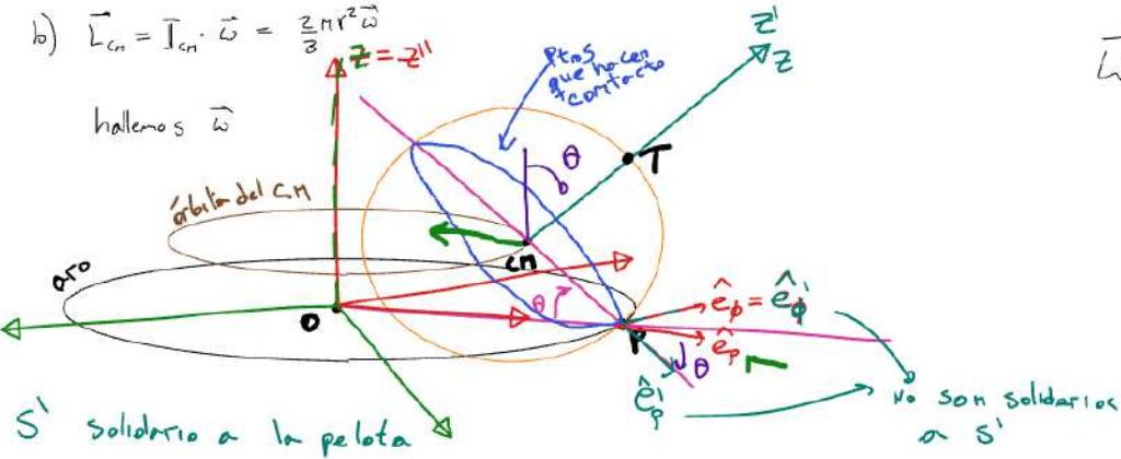
$S''$  rota siguiendo la rotación del C.M. en torno al eje  $\vec{z}$
