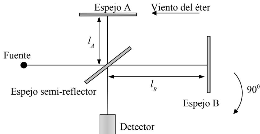
7. En el experimento original de Michelson-Morley los brazos del interferómetro medían 11 m y se utilizó luz de sodio ( $\lambda = 5900 \text{ \AA}$ ). El interferómetro podía revelar un corrimiento mínimo de 0.005 franjas. ¿Qué velocidad límite de la Tierra respecto al éter arrojaría un resultado nulo en el experimento? Compare con la velocidad orbital de la Tierra:  $V_o = 3 \times 10^4 \text{ m/s}$ .
