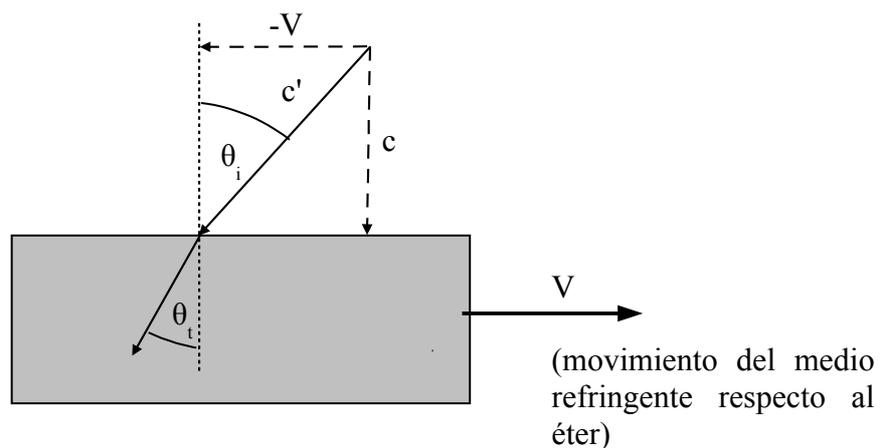
5. En 1851, Fizeau llevó a cabo un experimento para poner a prueba la hipótesis de Fresnel para la velocidad de la luz en medios móviles. En la figura se muestra esquemáticamente el arreglo experimental de Fizeau:
