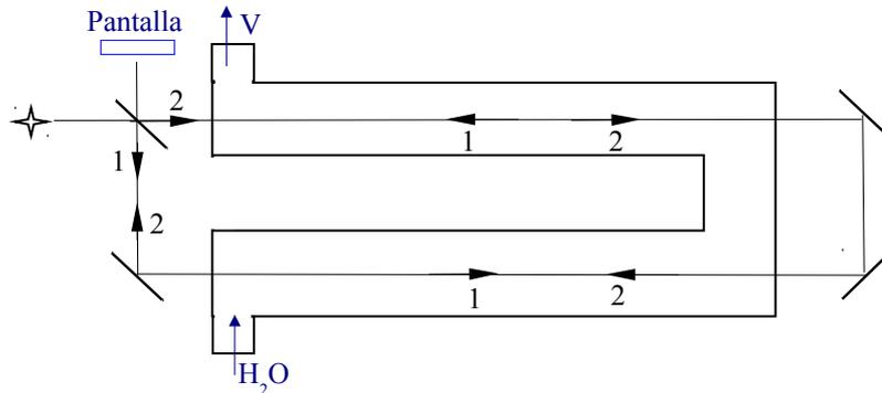
Dentro de los tubos se establece una corriente de agua con velocidad  $V$ . La fuente emite luz que es dividida, mediante un espejo semitransparente, en los rayos 1 y 2, de modo que el rayo 1 recorre los tubos (de longitud  $L$  cada uno) a favor de la corriente de agua y el rayo 2 en contra.
