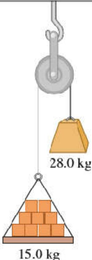
**Máquina de Atwood.** Una carga de 15.0 kg de ladrillos cuelga del extremo de una cuerda que pasa por una polea pequeña sin fricción y tiene un contrapeso de 28.0 kg en el otro extremo, como se muestra en la figura. El sistema se libera del reposo.
