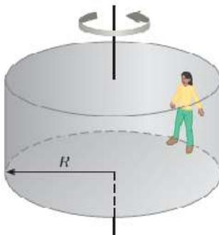
4.- Un juego mecánico de feria llamado "El Rotor" consiste de un cilindro giratorio con piso móvil, que desaparece cuando el tambor gira rápidamente (véase la figura). En su interior, las personas se mantienen en las paredes gracias a la fricción. El coeficiente mínimo de fricción esperado, entre las ropas de las personas y la pared es de  $0,50$ .
