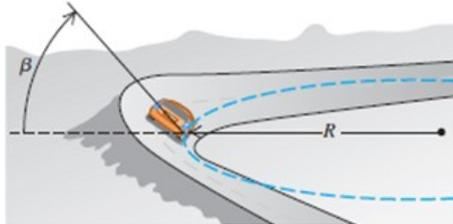
b) Para un automóvil que viaja con cierta rapidez, es posible peraltar una curva con un ángulo tal que el automóvil no necesite fricción para mantener el radio con que da vuelta. Entonces el automóvil podría tomar con seguridad la curva aún sobre hielo húmedo. Un ingeniero propone reconstruir la curva del ejemplo anterior de modo que un automóvil con rapidez  $v$  pueda dar la vuelta sin peligro aunque no haya fricción. ¿Qué ángulo de peralte  $\beta$  debería tener la curva?
