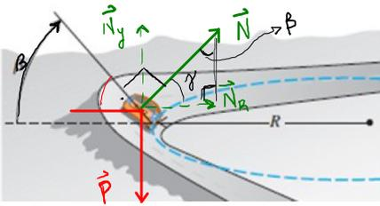
**b)** Para un automóvil que viaja con cierta rapidez, es posible peraltar una curva con un ángulo tal que el automóvil no necesite fricción para mantener el radio con que da vuelta. Entonces el automóvil podría tomar con seguridad la curva aún sobre hielo húmedo. Un ingeniero propone reconstruir la curva del ejemplo anterior de modo que un automóvil con rapidez  $v$  pueda dar la vuelta sin peligro aunque no haya fricción. ¿Qué ángulo de peralte  $\beta$  debería tener la curva?
