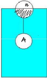
5.- Dos esferas de igual volumen están sujetas mediante un hilo de masa despreciable. La esfera inferior tiene una masa tres veces mayor que la superior. El conjunto se halla sumergido en agua, de modo que en equilibrio, sólo queda por encima del nivel del agua la mitad de la esfera superior, tal como se muestra en la figura. Si el volumen de cada esfera es de  $1,30 \text{ dm}^3$ , ¿cuánto vale la tensión del hilo?
