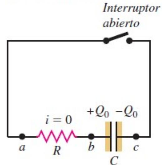
b) Descarga del capacitor
