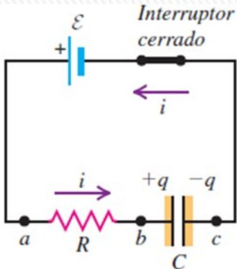
A medida que el capacitor se va cargando, su voltaje  $v_{bc}$  aumenta, mientras que el voltaje del resistor  $v_{ab}$ , disminuye, cumpliéndose que:  $\mathcal{E} = v_{ab} + v_{bc}$ .
