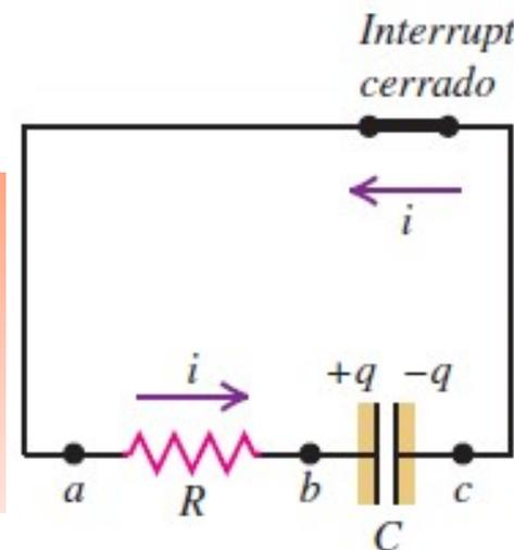
Cuando se cierra el interruptor, tanto la carga en el capacitor como la corriente disminuyen con el tiempo.
