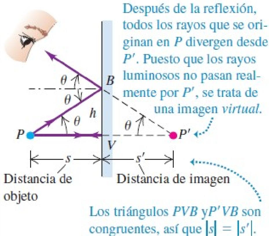
Para determinar la ubicación de la imagen virtual  $P'$  en un espejo plano usaremos la construcción de la figura: dos rayos que divergen a partir de un **punto de objeto  $P$**  situado a una **distancia  $s$**  (ó  $p$  según notación de Serway) a la izquierda de un espejo plano.
