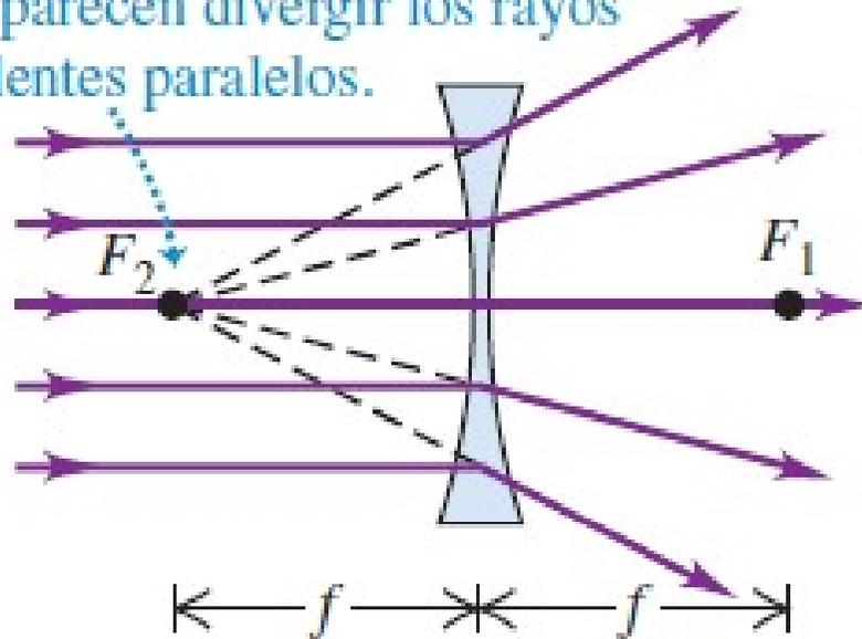
La figura muestra una lente divergente; el haz de rayos paralelos que incide en esta lente diverge después de refractarse. La distancia focal de una lente divergente es una cantidad negativa.
