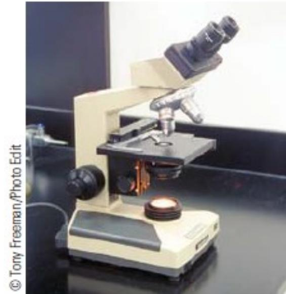
El microscopio compuesto está constituido por una lente, el **objetivo**, que tiene una distancia focal muy corta, menor a 1 cm, y una segunda lente, el **ocular**, que tiene una distancia focal de unos cuantos centímetros.
