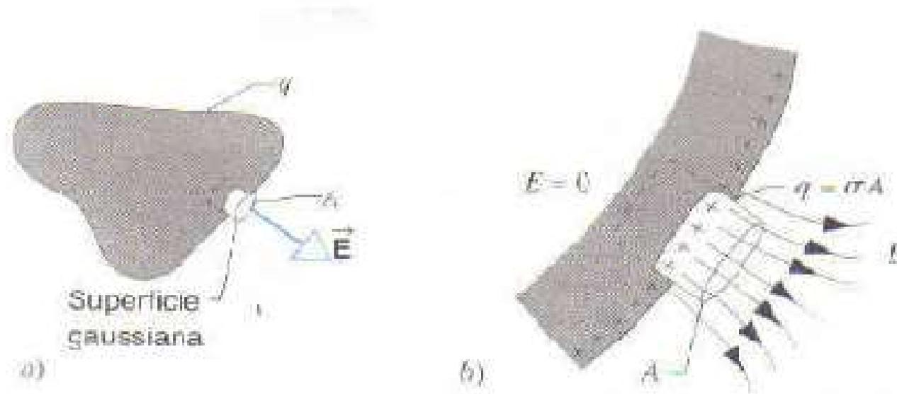
**FIGURA 27-15.** *a)* Una pequeña superficie gaussiana se colocó sobre la superficie de un conductor cargado. *b)* Vista ampliada de la superficie gaussiana que encierra una carga  $q$  igual a  $\sigma A$ .
