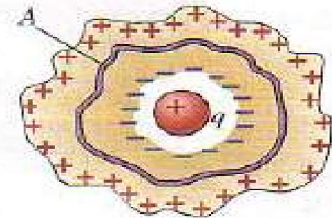
**22.24** (a) En un conductor sólido la carga reside en su totalidad en la superficie externa. (b) Si no hay carga en el interior de la cavidad del conductor, la carga neta en la superficie de la cavidad es cero. (c) Si hay una carga  $q$  adentro de la cavidad, la carga total en la superficie de la cavidad es  $-q$ .
