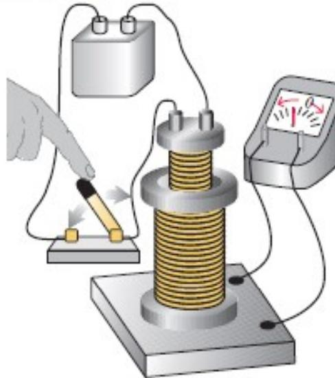
c) Si se cambia el imán por una 2da. bobina conectada a una batería, sucede lo mismo que con el imán..
