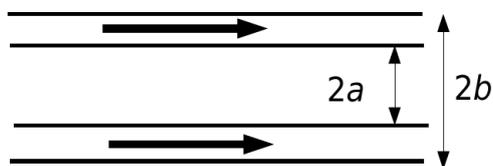
4. Considere el flujo de un fluido viscoso e incompresible entre dos paredes paralelas localizadas en  $z = h$  y  $z = -h$ , sometido a un gradiente de presiones constante  $\nabla p = (-D, 0, 0)$ .
