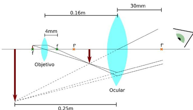
**5.14-** Un microscopio tiene un objetivo de 4,00 mm de distancia focal y un ocular de distancia focal 30,0 mm. Las dos lentes se hallan a 0,16 m de distancia entre ellas, y la imagen final se forma a 0,25 m del ocular.
