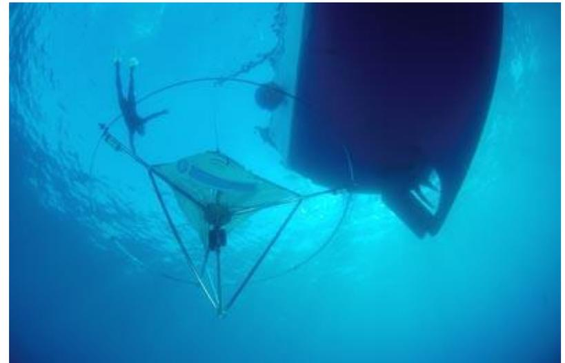
Sistema sonar pasivo consiste en una cadena de aparatos de escucha pasiva que detectan cetáceos alrededor 3D y transmiten en tiempo real avisos a embarcaciones cercanas.
