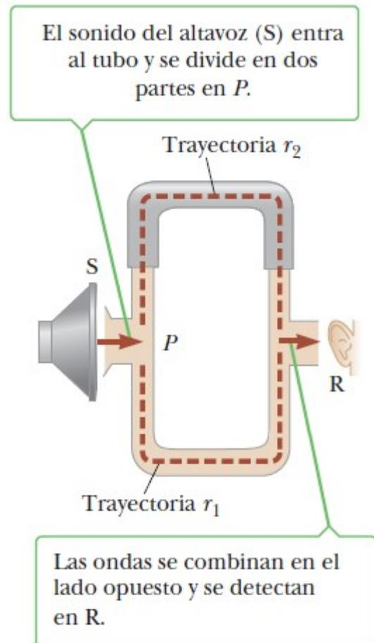
Las ondas de sonido se pueden interferir una con otra, Se puede visualizar con el dispositivo mostrado.
