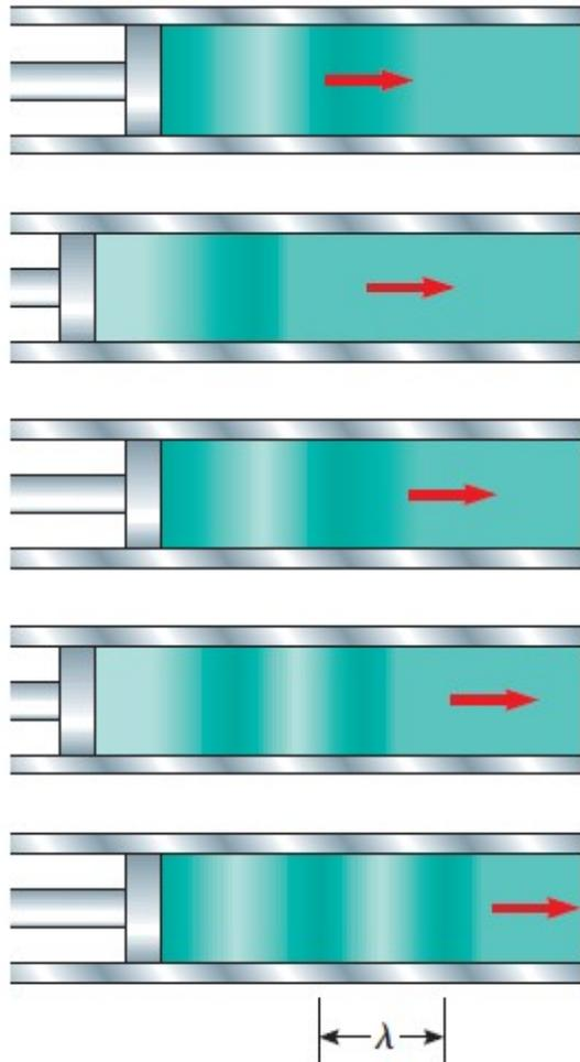
Onda sonora periódica unidimensional en tubo con gas, generado por pistón en oscilación en un extremo.
