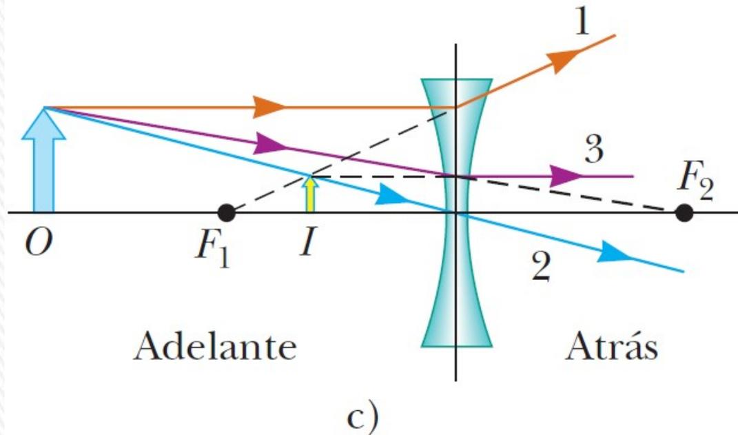
Rayo 1: se dibuja paralelo al eje principal. Después de ser refractado por la lente, emerge alejándose desde el foco  $F_1$  en la cara frontal de la lente.
