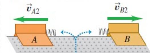
El sistema de los dos deslizadores tiene la misma energía cinética después del choque que antes de este.
