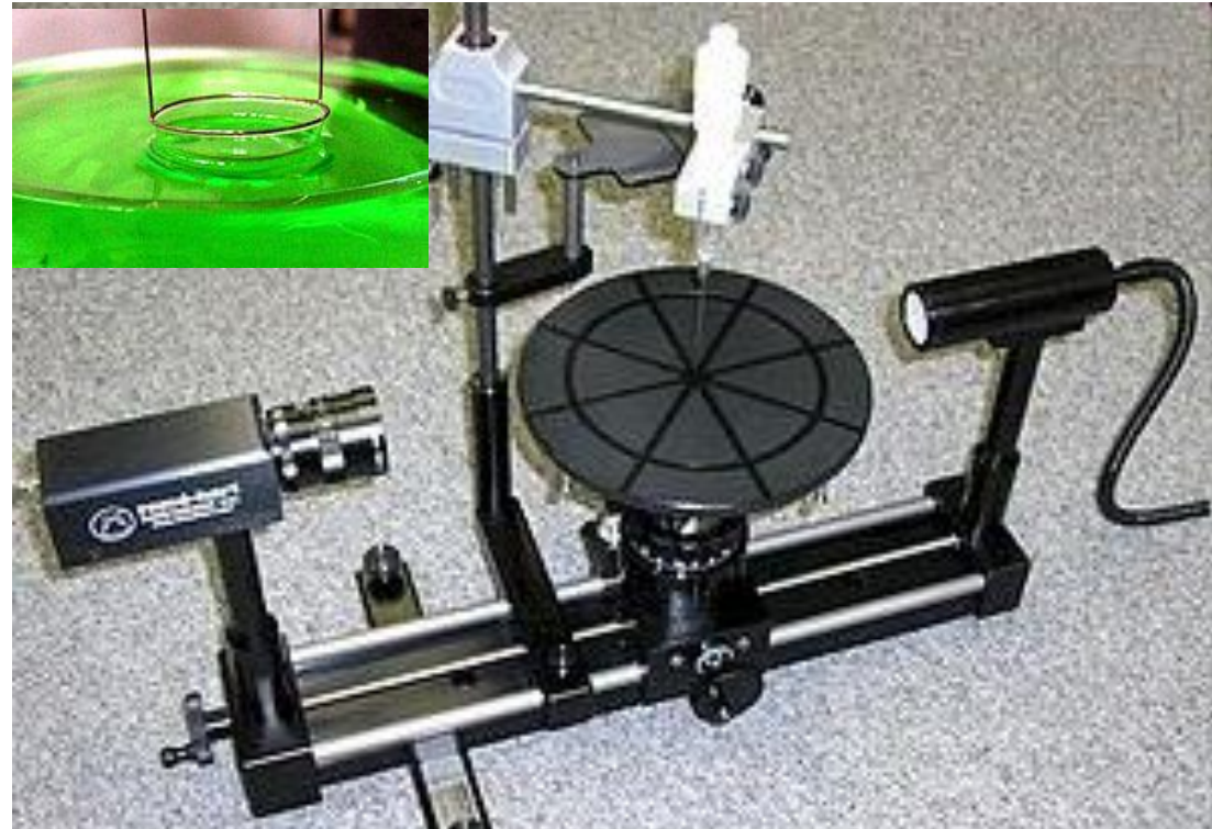
Método Goniométrico de du Noüy-Ring
