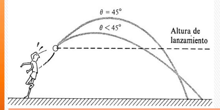
Lanzamiento efectuado por encima del nivel del suelo. La trayectoria para un ángulo de tiro de 45° y otro más pequeño se cortan por debajo de la altura de lanzamiento. La trayectoria más plana tiene un mayor alcance. Si el punto de llegada está a mayor altura que el de lanzamiento, el alcance máximo se alcanza con un ángulo de lanzamiento mayor a 45°.
