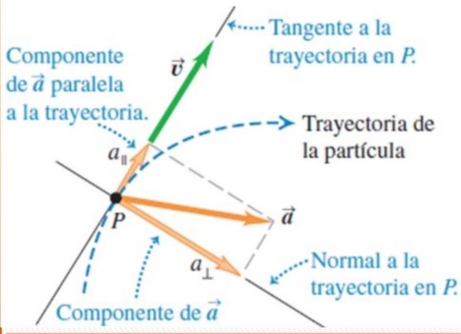
El vector  $\overline{a}$  se puede visualizar en términos de una componente paralela a la trayectoria de la partícula (paralela a la velocidad), y otra componente perpendicular a la trayectoria, (perp endicular a la velocidad).
