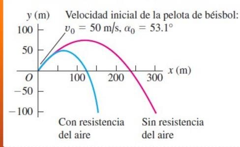
La fricción del aire tiene un efecto apreciable sobre los proyectiles, en especial los que son *ligeros y rápidos;* la resistencia es proporcional al cuadrado de la velocidad.
