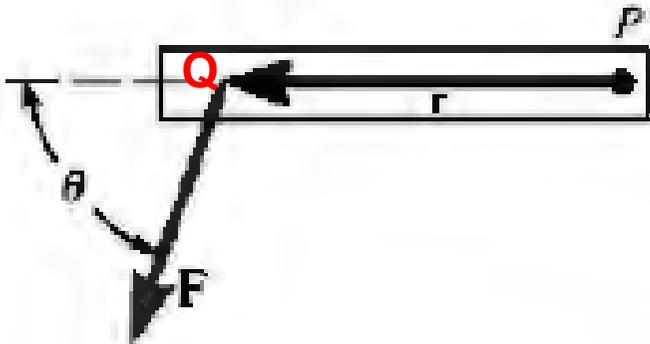
El **momento** o **torque**  $\tau$  depende de la fuerza  $F$ , de la **distancia**  $r$  desde un punto del eje de rotación hasta el punto en que actúa la fuerza y del **ángulo**  $\theta$  entre  $r$  y  $F$ .
