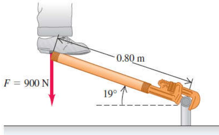
Para aflojar una junta de tubería, un plomero inserta un pedazo de tubo (una “extensión”) en el mango de su llave. Se coloca de pie en el extremo del tubo, aplicando todo su **peso de 900 N** en un punto a **0,80 m del centro de la junta**. *El mango de la llave y la extensión* forman un ángulo de  **$19^\circ$  con la horizontal**. Encuentre la magnitud y dirección del torque que se aplica en torno al centro de la junta.
