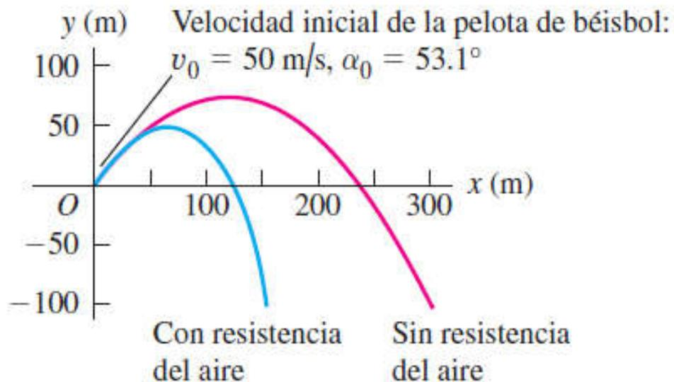
La fricción del aire tiene un efecto apreciable sobre los proyectiles, en especial los que son *ligeros y rápidos*; **la resistencia es proporcional al cuadrado de la velocidad.**
