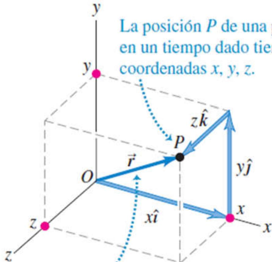
El vector de posición del punto  $P$  tiene las componentes  $x$ ,  $y$ ,  $z$ :
