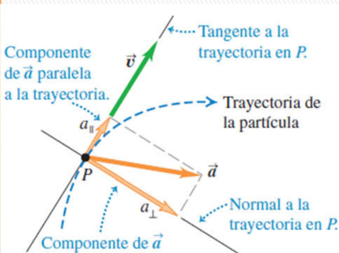
El vector  $\vec{a}$  se puede visualizar en términos de una **componente paralela a la trayectoria de la partícula (paralela a la velocidad)**, y otra **componente perpendicular a la trayectoria**, (perpendicular a la velocidad).
