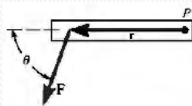
El **momento** o **torque**  $\tau$  depende de la **fuerza**  $F$ , de la **distancia**  $r$  desde un punto del eje de rotación hasta el punto en que actúa la fuerza y del **ángulo**  $\theta$  entre  $r$  y  $F$ .
