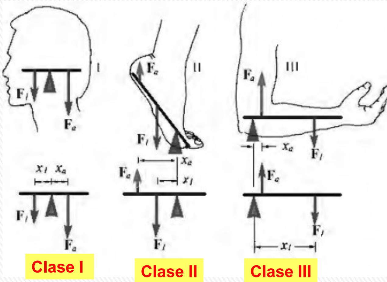
Una **palanca** es en esencia una barra rígida utilizada con un punto de apoyo (fulcro).
