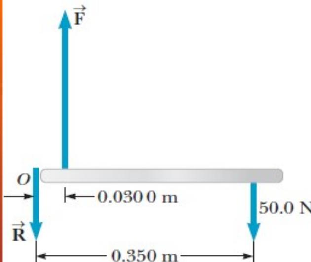
Las fuerzas que actúan sobre el antebrazo son equivalentes a las que actuarían sobre una barra de longitud 0,350 m, como se muestra: Elijo las coordenadas  $x$  y  $y$  de manera usual como se muestra y el eje en  $O$  en el extremo izquierdo, y uso las condiciones de equilibrio para establecer ecuaciones que involucren a las incógnitas  $F$  y  $R$ . La sumatoria de los torques respecto a cualquier punto debe ser cero, por lo que elijo respecto al punto  $O$ .
