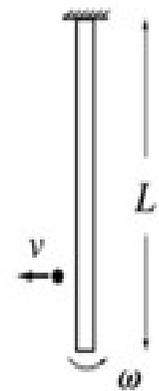
En esta situación se conserva el momento angular, ya que no hay ningún torque externo respecto al pivote realizado sobre el sistema barra-pelota. En cambio el momento lineal, no se va a conservar, ya que el pivote ejerce una fuerza externa sobre la barra, que le impide que se desplace, solamente puede girar.
