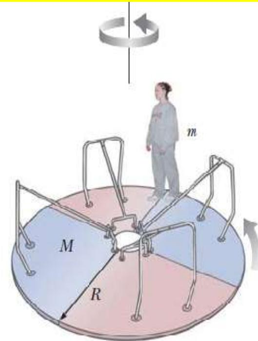
Como no hay ningún torque externo que actúe sobre el sistema plataforma + estudiante, el momento angular se va a conservar y por tanto:  $I\omega = \text{cte}$ .
