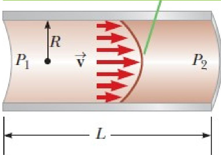
La caída de presión  $\Delta P = P_1 - P_2$  a lo largo de un tubo horizontal de sección transversal constante es proporcional a:
