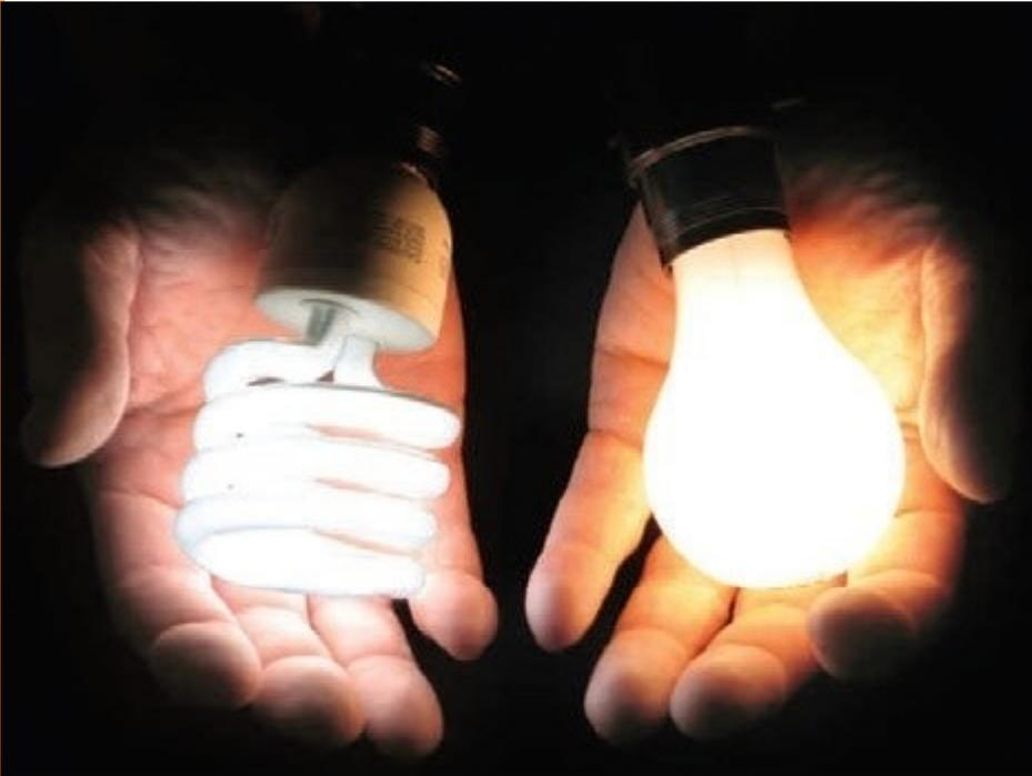
Dos lámparas de luz: de igual potencia de salida lumínica, pero la lámpara fluorescente de la izquierda, produce esta iluminación con mucho menos potencia eléctrica que la incandescente de la derecha. Las lámparas fluorescentes (“de bajo consumo”), es menos costosa de operar, pues consume menos potencia y resulta más económica.
