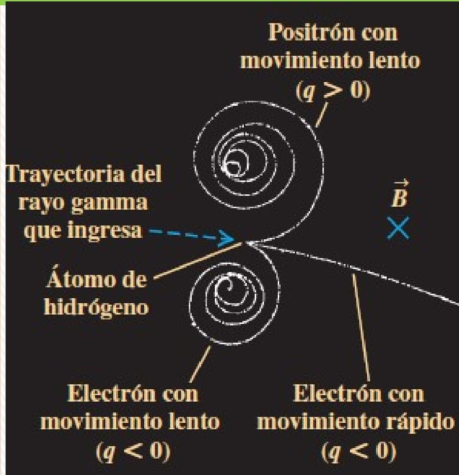
Cámara llena de hidrógeno líquido y con un  $B$  entrante
