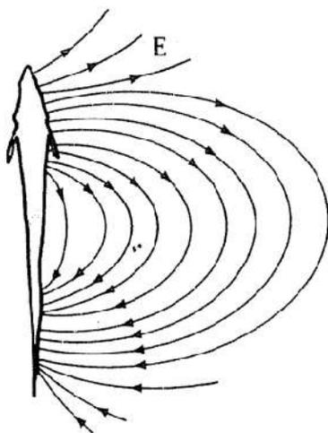
**1.2.14- Peces débilmente eléctricos.** Ciertos peces emplean el campo eléctrico para la detección y comunicación. Para ello generan un campo eléctrico de tipo dipolo (ver figura), y poseen un órgano que es capaz de detectarlo.
