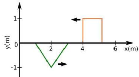
**4.1.8-** Sobre una cuerda dada se transmiten dos pulsos, uno triangular y uno rectangular, como muestra la figura. Hacer un esquema de la forma de la cuerda transcurridos 1,00 s, 1,25 s y 1,50 s después del instante que se muestra. Considerar que la velocidad de los pulsos de onda es 1,00 m/s.
