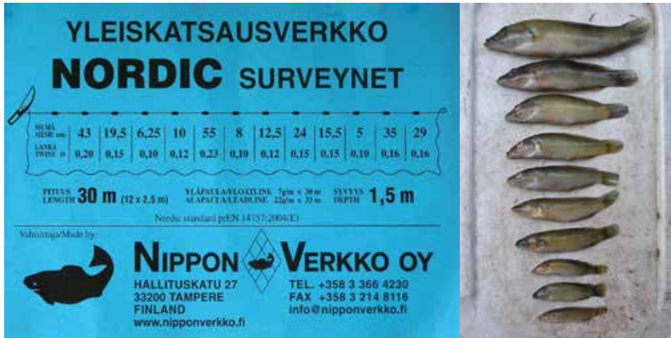
Figura 10. Izquierda, esquema de red estandarizada, la numeración superior que comienza en 43 muestra el tamaño de las mallas en mm y el orden de cada paño en la red. La numeración de abajo que comienza en 0,2 muestra el diámetro de la línea correspondiente a cada malla. Derecha, muestra distribución de tallas de Crenicichla missioneira colectados en el Río Uruguay. Foto: Franco Teixeira de Mello.
