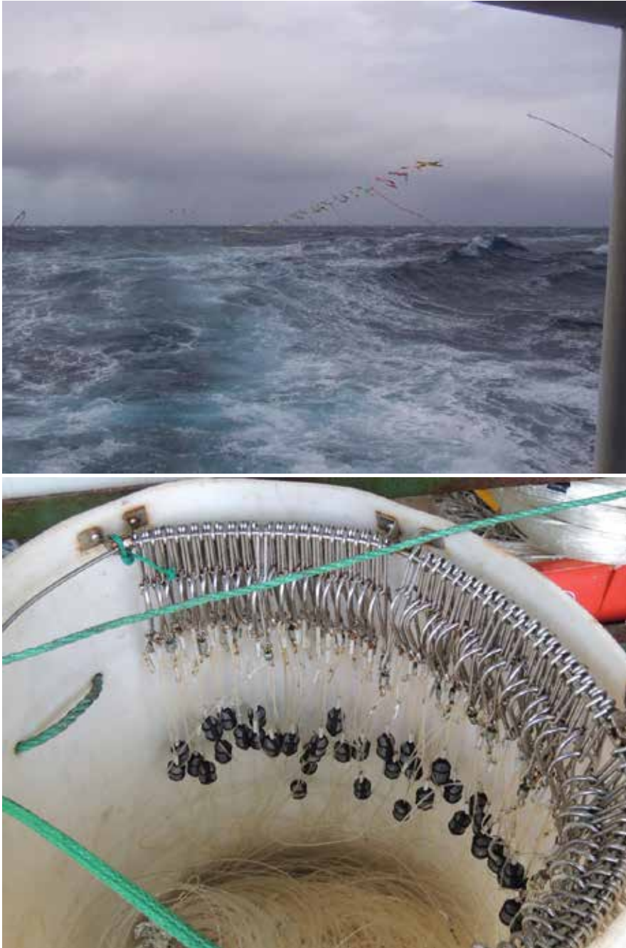
Figura 3. Algunas medidas de mitigación usadas en Uruguay en palangre pelágico. Arriba: línea espantapájaros (Domingo et al. , 2017). Esta medida de mitigación ahuyenta a las aves de la zona donde se están hundiendo los anzuelos encarnados. Abajo: pesos en las brazoladas (Jiménez et al. , 2019). Los pesos colocados próximos a los anzuelos incrementan significativamente la tasa de hundimiento de los anzuelos encarnados, reduciendo su exposición a las aves. Fotos: S. Jiménez.
