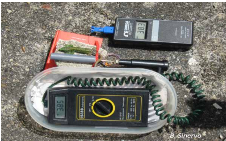
Figura 4. Calibración de modelo para medir T_e . El modelo (caño gris) y la lagartija están conectados a sensores de temperatura que registran al mismo tiempo la temperatura que ambos están presentando como resultado de la exposición, en este caso, al sol. Foto: Barry Sinervo.
