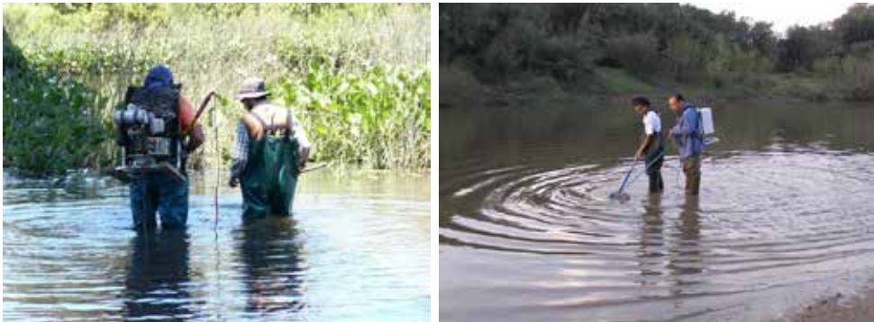
Figura 5. Pesca eléctrica de mochila. Arriba: equipo a baterías. Abajo: equipo a motor. Fotos: Marcelo Loureiro.
