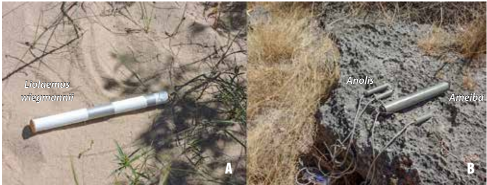
Figura 5. Modelos utilizados para medir T_e . Se indican la especie, en el caso de (A), y de los géneros de lagartijas, en el caso de (B), al que estarían representando los modelos. Los modelos son de PVC y se encuentran conectados a un sensor de temperatura. Fotos: A) Ernesto Elgue. B) Barry Sinervo y Donald Miles.
