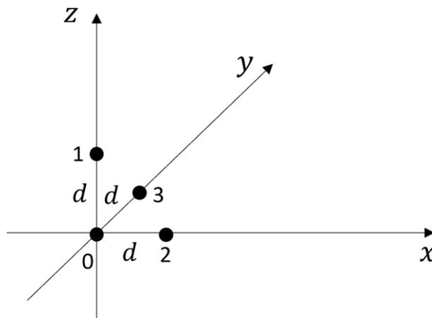
Con el mismo procedimiento del punto anterior podemos hallar la distancia  $r_1, r_2, r_3$  de la fuente a los puntos 1, 2 y 3 respectivamente. En un sistema de coordenadas con origen en  $r_0$ , es posible determinar unívocamente la posición  $(x_f, y_f, z_f)$  de la fuente pues cumple con las siguientes ecuaciones:
