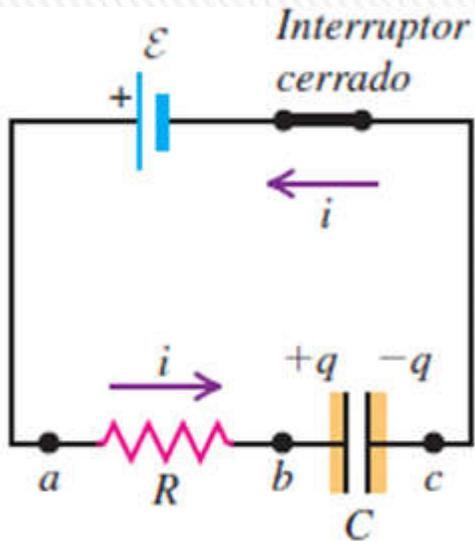
A medida que el capacitor se carga, su voltaje  $v_{bc}$  aumenta, mientras que el voltaje del resistor  $v_{ab}$ , disminuye, cumpliéndose que:  $\mathcal{E} = v_{ab} + v_{bc}$ .
