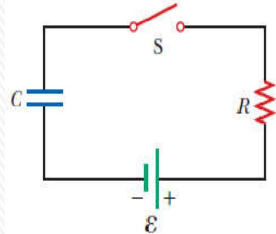
a) Constante de tiempo  $\tau = RC = (1,00 \times 10^6 \text{ }\Omega)(5,00 \times 10^{-6} \text{ F}) = 5,00 \text{ s}$
