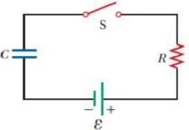
2.1.14- Considere el circuito  $RC$  en serie de la figura en el cual  $R = 1,00 \text{ M}\Omega$ ,  $C = 5,00 \mu\text{F}$  y  $\varepsilon = 30,0 \text{ V}$ . Encuentre:
