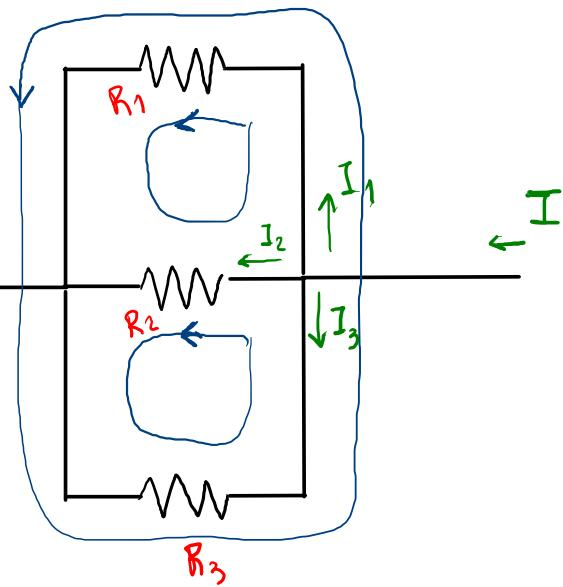
$$\begin{cases} I_1 R_1 - I_2 R_2 = 0 \\ I_2 R_2 - I_3 R_3 = 0 \\ I_1 R_1 - I_3 R_3 = 0 \end{cases}$$
