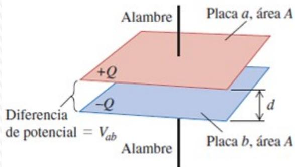
**Capacitor de placas paralelas:** dos placas conductoras paralelas, cada una con una superficie  $A$ , separadas una distancia  $d$ . Cuando se carga el capacitor al conectar las placas a las terminales de una batería, las placas adquieren cargas de igual magnitud. Una de las placas tiene carga positiva y la otra carga negativa.
