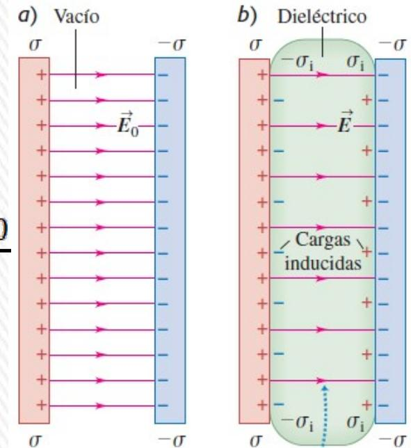
Para una densidad de carga determinada  $\sigma$ , las cargas inducidas en las superficies del dieléctrico reducen el campo eléctrico entre las placas.
