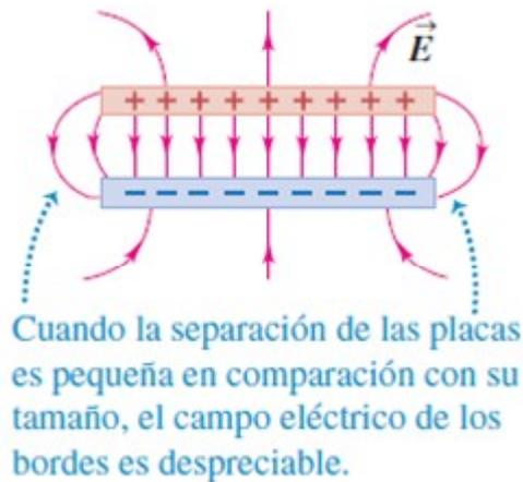
Si las placas están muy juntas (en comparación con su longitud y ancho), se puede suponer que el campo eléctrico es uniforme entre las placas y cero en cualquier otra parte.
