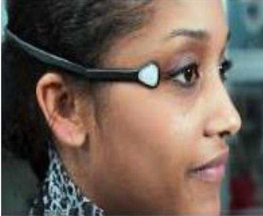
**Dosímetro DOSIRIS:** cinta cabecera rígida con alojamiento para el TLD cubierto por ambos lados por una capa de polipropileno de 3 mm de espesor.
