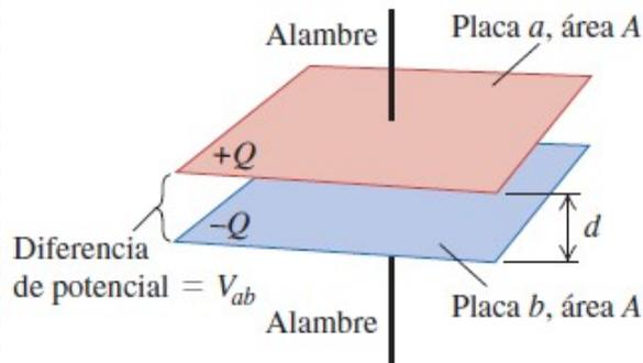
Capacitor de placas paralelas: dos placas conductoras paralelas, cada una con una superficie  $A$ , separadas una distancia  $d$ .
