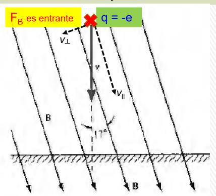
En un punto sobre la superficie de la Tierra el campo magnético terrestre forma un ángulo de 17° con la vertical y tiene una magnitud de 5,8 × 10<sup>-5</sup> T.
