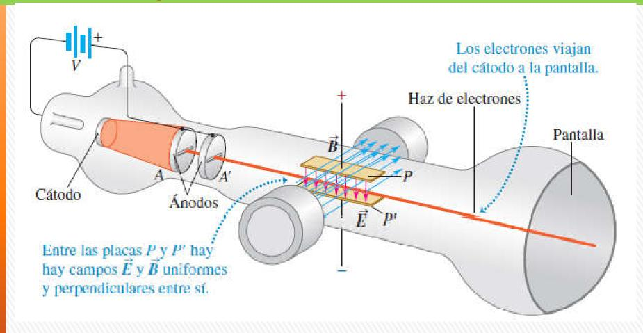
En 1897 J.J. Thomson realizó uno de los experimentos cruciales de la física basándose en la idea anterior y midió la razón *e/m* que hay entre la carga y la masa del electrón. En un contenedor de vidrio al alto vacío se aceleraron electrones provenientes de un cátodo caliente, para formar un haz mediante una diferencia de potencial *V entre los dos ánodos A y A' La rapidez v de los* electrones estaba determinada por el potencial acelerador *V.*
