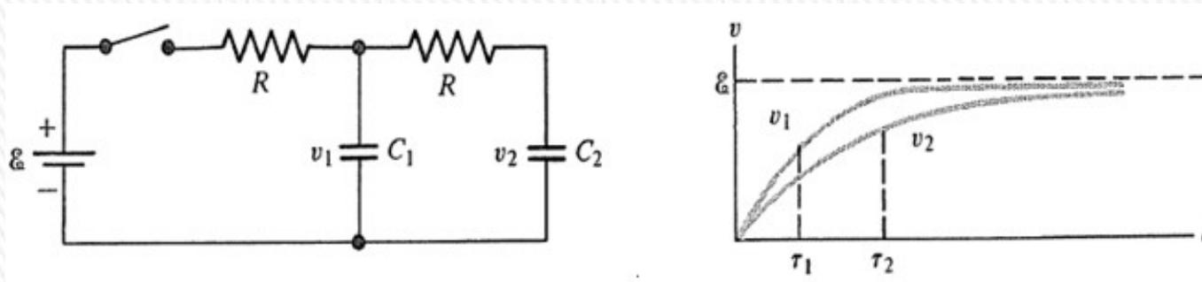
La diferencia de potencial  $v_2$  en  $C_2$  crece más lentamente que la diferencia de potencial  $v_1$  a través de  $C_1$ , ya que el camino desde la batería hasta  $C_2$  y regreso tiene una resistencia  $2R$ .
