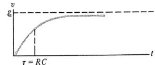
Si la carga inicial  $q$  del capacitor  $C$  es cero y el interruptor se cierra en el instante  $t=0$ , la carga  $q$  y la diferencia de potencial  $v = q/C$  aumentarán gradualmente. El tiempo necesario necesario para alcanzar un 63,2% de los valores finales de  $q$  y de  $v$  viene determinado por la constante de tiempo  $\tau = RC$ .
