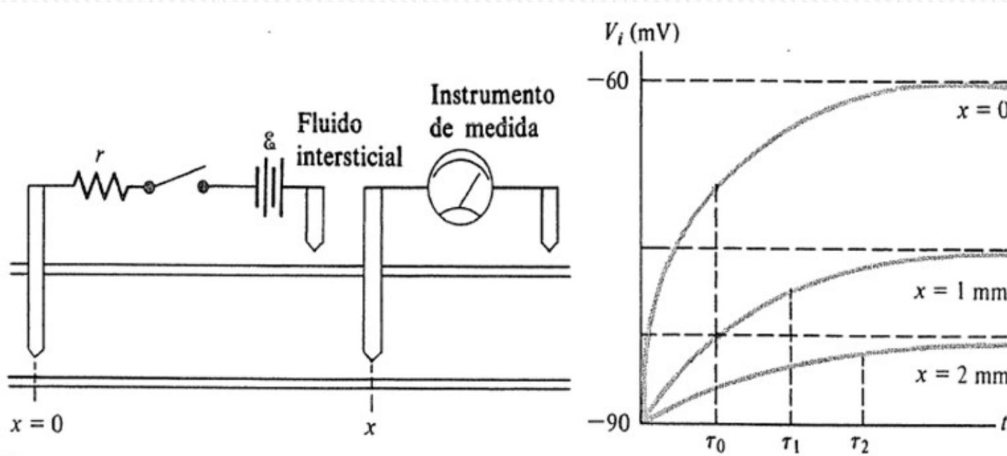
Una sonda conectada a una batería se inserta en  $x = 0$ , y *poco a poco el potencial del axón  $V_i$ ; en aquel punto cambia de  $-90$  mV a  $-60$  mV*. El tiempo necesario para que se produzca este cambio viene determinado por la capacidad de la membrana y la resistencia externa  $r$ . *A otros valores de  $x$ , los potenciales cambian más lentamente, alcanzando un potencial final entre  $-90$  mV y  $-60$  mV.*
