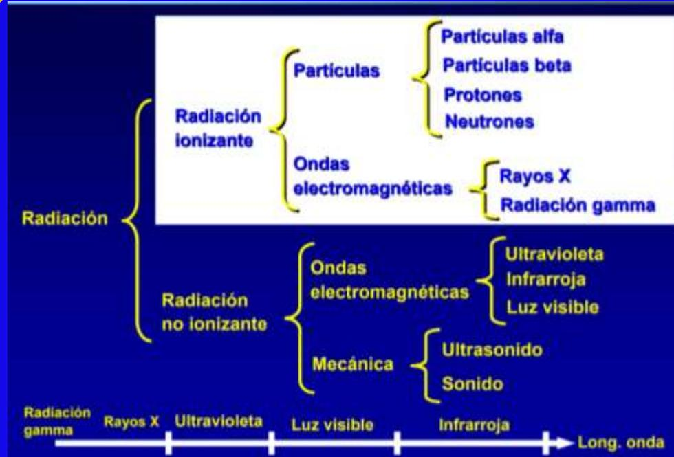
Los electrones arrancados y los iones formados, por la ionización, pueden interactuar y producir cambios en el material. Esto le da, a las radiaciones ionizantes, la capacidad de romper enlaces químicos que mantienen a las moléculas unidas. Cuando la ionización ocurre en las células vivas, pueden producir cambios químicos con efectos dañinos. La Protección Radiológica se ocupa de minimizar esos posibles efectos dañinos en los seres humanos
