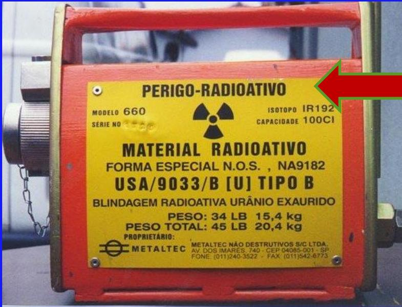
El equipo debe estar marcado de conformidad con la norma ISO 361, como mínimo, marcados con el símbolo de la radiación (el trébol) y la inscripción “RADIOACTIVO”. También deberían marcarse de forma duradera con el número de serie del fabricante
