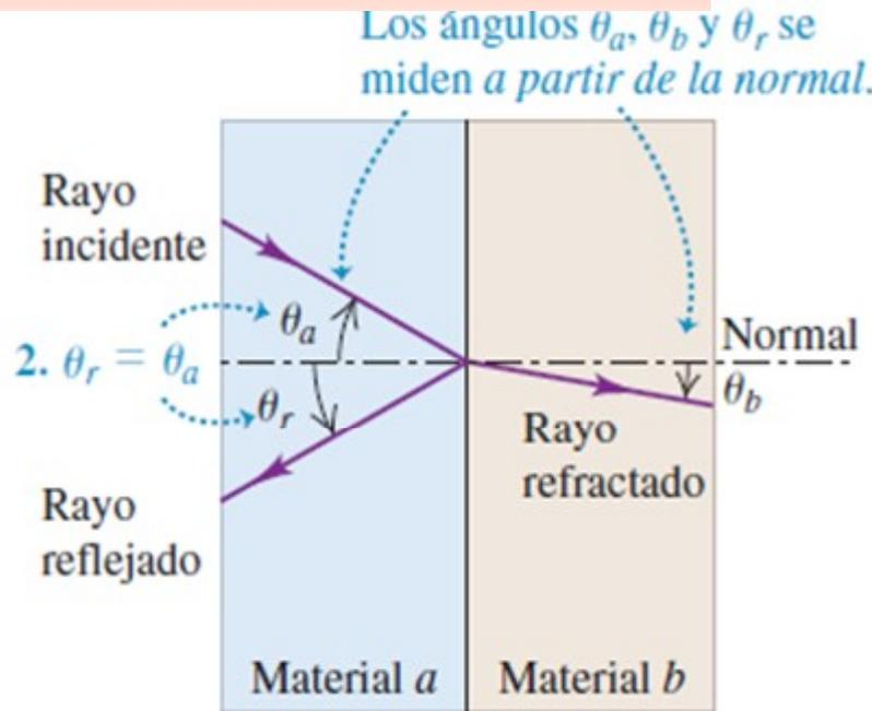
$$n \equiv \frac{\text{rapidez de la luz en el vacío}}{\text{rapidez de la luz en el medio}} \equiv \frac{c}{v}$$
