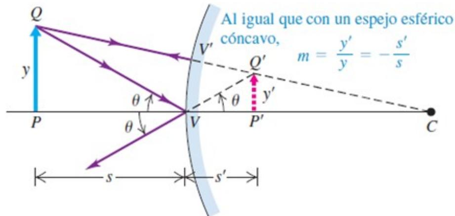
Se muestran dos rayos que divergen a partir de la punta de la flecha PQ y de la imagen virtual P'Q'.
