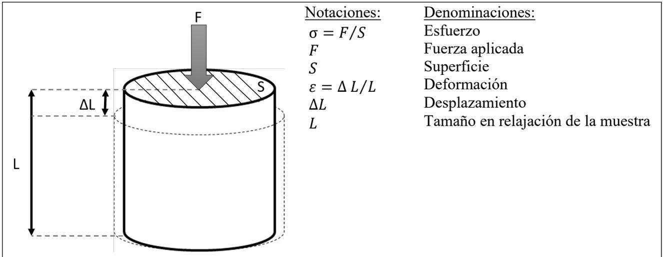
El gel es muy frágil y, en consecuencia, pedimos que no lo saquen del recipiente en el cual se encuentra. La carga máxima que se le puede aplicar al gel es de 10N (~1kg). Se puede medir la altura  $L$  del gel sacando sólo la tapa (cilindro interno) y usando un calibre.
