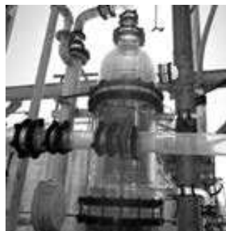
Figura 4.17 Producción industrial del bromo (un líquido rojo fumante) a través de la oxidación con cloro gaseoso de una disolución acuosa con contenido de iones \text{Br}^- .
