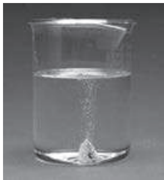
Los alcoholes reaccionan con más lentitud con el sodio metálico que éste con el agua.
