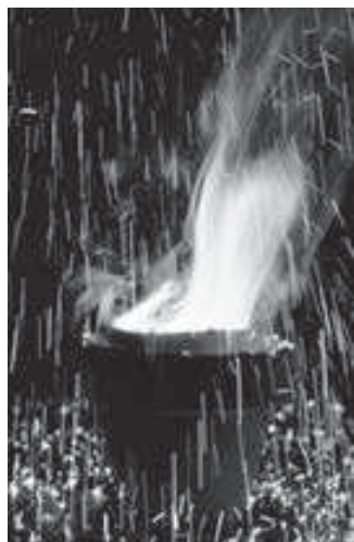
Figura 13.16 La temperatura de una reacción termita puede alcanzar casi 3 000°C.
