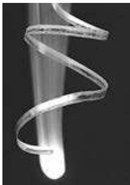
Cuando el magnesio se quema en el aire, forma óxido de magnesio y nitruro de magnesio.
