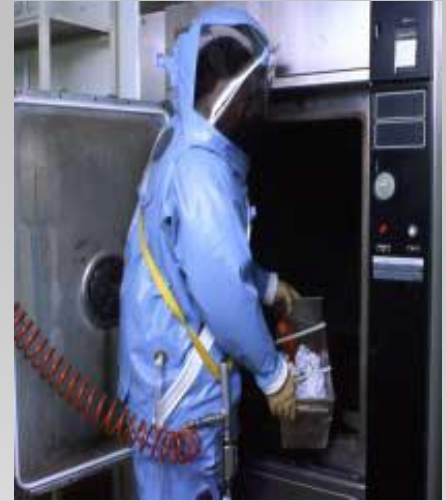
Autoclave doble puerta
