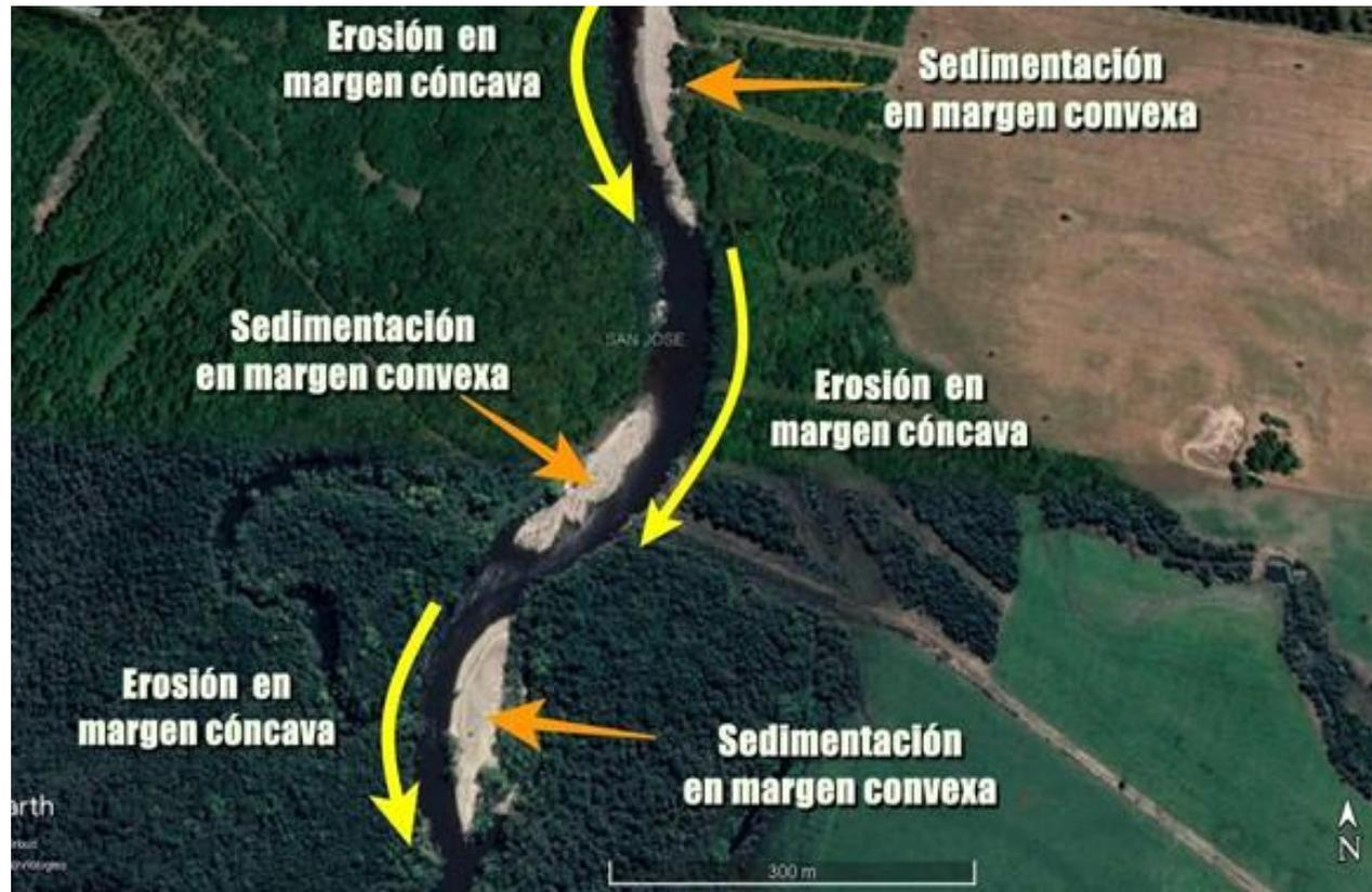
A lo largo de un curso fluvial, se pueden observar en el lecho del cauce, **sedimentos de diferentes granulometrías** (guijarros, arenas, limos y arcillas) con pocos metros de diferencia, que se **erosionan, transportan y acumulan**.
