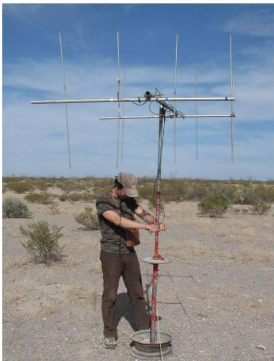
**Figura 12.- Sistema de Pico-Nulo montado en una estación fija. El sistema de pico nulo se conforma por dos antenas Yagui con exactamente las mismas características, montadas en forma paralela y conectadas entre sí. El sistema pico nulo sirve para obtener de forma muy precisa la dirección en la que se encuentra un radio collar (Fotografía M. Hidalgo).**
