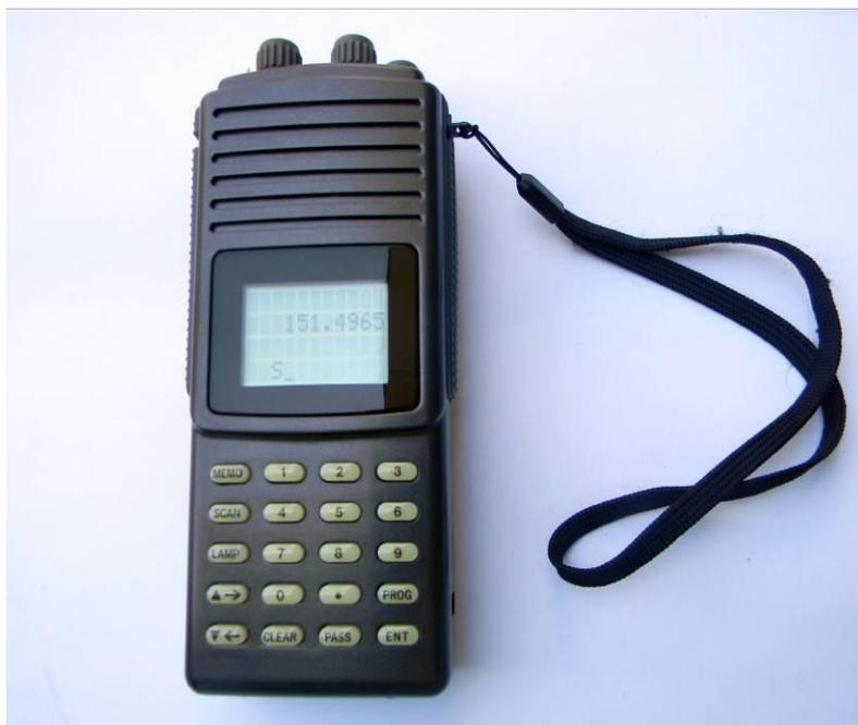
**Figura 14.- Fotografía de un receptor digital con capacidad de realizar escaneo de frecuencias previamente programadas por el usuario (Fotografía L. Pérez-Solano).**
