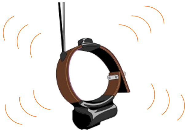
Transmisor VHF (equipo que emite la señal)
