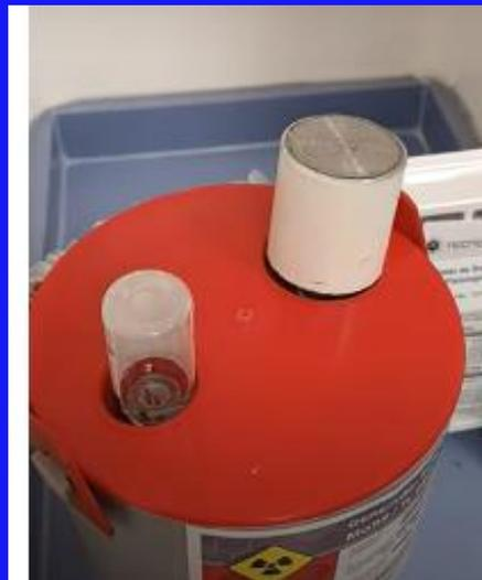
Según el cálculo realizado con el código Microshield versión 4, considerando 500 mCi de  $^{99m}\text{Tc}$  en un contenedor de plomo de 5 mm de espesor produce una tasa de dosis a 0.3 m del contenedor de 48.1 nSV/h.
