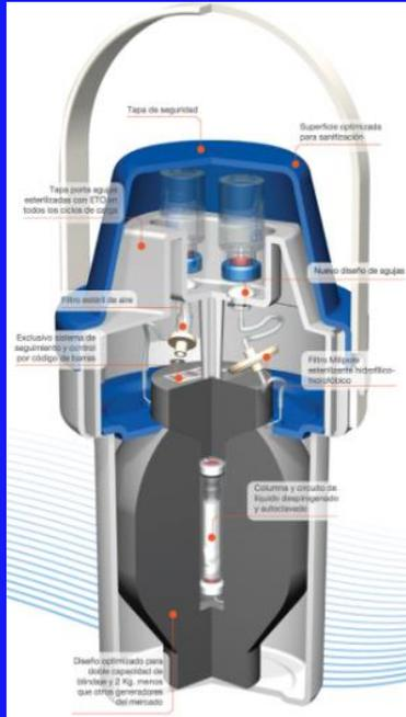
Según el cálculo realizado con el código Microshield versión 4, considerando 500 mCi de  $^{99m}\text{Tc}$  en un contenedor de plomo de 5 mm de espesor produce una tasa de dosis en la superficie del contenedor igual a 14.18  $\mu\text{Sv/h}$  para el primer día de elución (lunes).
